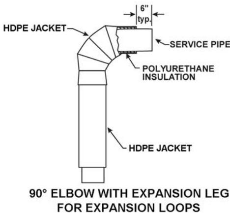
**90° ELBOW WITH EXPANSION LEG FOR EXPANSION LOOPS**
